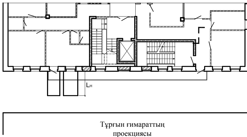
14.11-сурет – Ғимарат қасбетіндегі жалынның тік проекциясы
