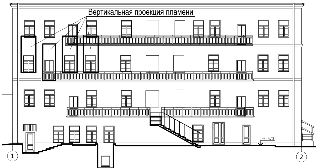
Рисунок 14.6 – Вертикальная проекция пламени на фасаде здания
