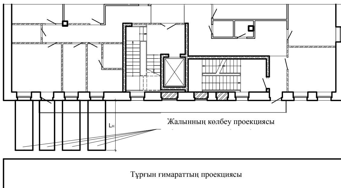
14.8-сурет – Ғимарат қасбетіндегі жалынның көлбеу проекциясы
