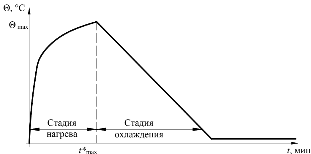
Рисунок 8.1 – Основные стадии параметрического режима пожара
